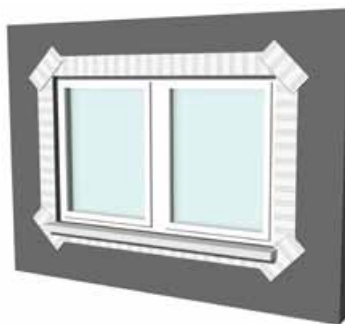
Obrázek č. 8: Vytužení okrajů stavebních otvorů sklotextilní tkaninou
